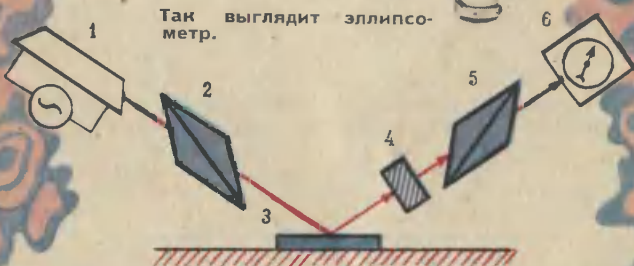
1 — лазер; 2 — поляризатор; 3 — объект; 4 — компенсатор; 5 — анализатор; 6 — индикатор.
